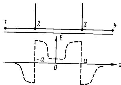
Здесь мы рассмотрим задачу о протекании тока в проводнике с ВЗП в геометрии, изображенной на рис. и покажем, что специфика отклика фазы ВЗП на электрическое поле приводит к результатам, качественно согласующимся с данными эксперимента. Кроме того будут предсказаны эффекты (например, рождение фазовых солитонов на kontaktах 2 и 3), которые, по-видимому, можно наблюдать в будущих экспериментах.
