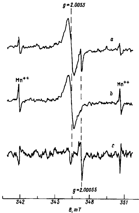
Рис.2. Спектры ЭПР КОНО-структур: а) с локализованными дырками; б) исходная неполяризованная структура; в) разностный спектр, полученный вычитанием спектров а и б
